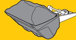
Der maximal anbaubare Schaufelinhalt. Der anbaubare Schaufelinhalt wird über die Kipplast und die Nennlast ermittelt!
